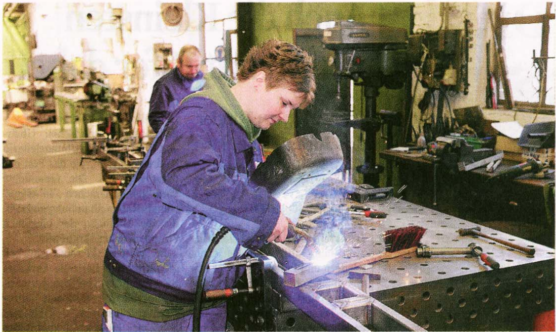
Ramona Geil wird Konstruktionsmechanikerin. Sie lernt dafür das Schweißen mit Schutzgas.
